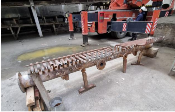
Resim 1. Isı Geçirmeyen Deforme Olmuş (Finli) Kanatlı Boru
