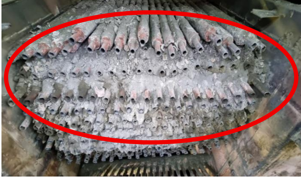
Resim 1. Isı Geçirmeyen Deforme Olmuş (Finli) Kanatlı Boru
