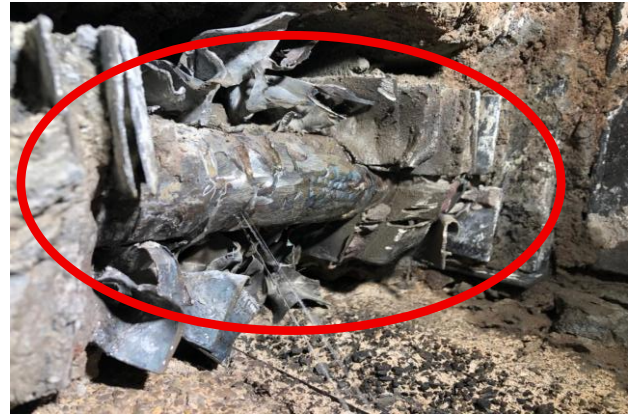
Resim 2. Tavllanmış ve Erozyona Uğramış Dirsek
